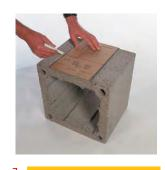
Iscrtajte otvor za vratanca dimnjaka. Širina otvora treba da je 23 cm. Isecite otvor prema linijama po celoj visini plašta.
